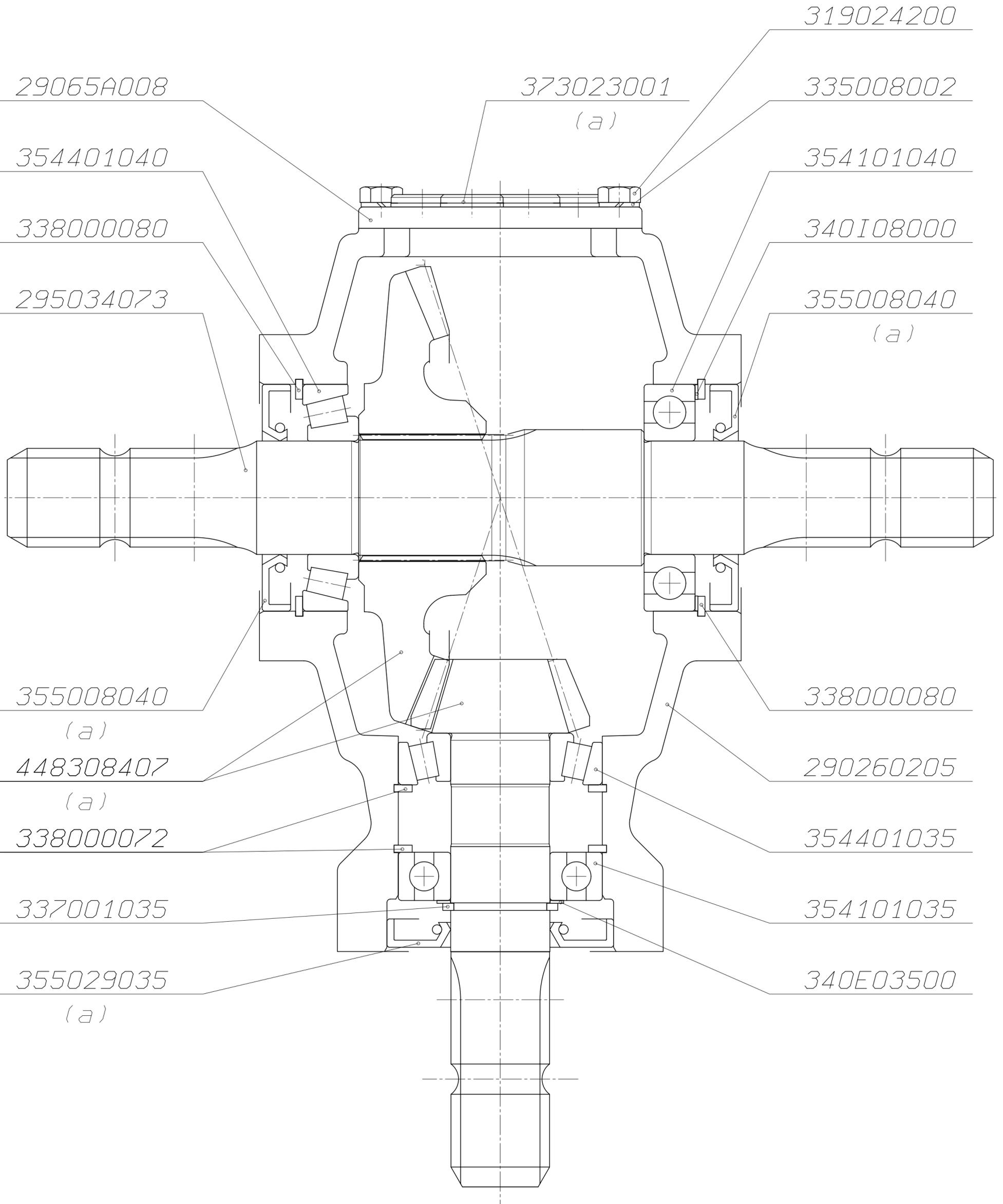
a SOSTITUITO ELENCO E NUMERAZIONE DEI SINGOLI COMPONENTI CON INDICAZIONE DIRETTA DEL CODICE: SOSTITUITA COPPIA CONICA, TAPPI, ANELLI DI TENUTA E VITI ERANO RISPETTIVAMENTE CODICE 448310500-373010000-355002040-355006035 310008000. ELIMINATA GUARNIZIONE CODICE 298300019. 10/05/2002Magotti
